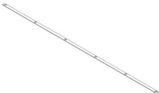
F01 BARRE PLATE -A4M02859 (x4) 1/16"x1"x65 7/8" (2x25x1673)
