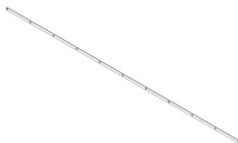
F02 SANGLE DE LIAISON À GRILLE - (x4) A4M02860 1/8"x5/8"x68 1/16" (3x20x1730)
