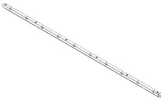
M02 BÂTI À PERSIENNES - A4M02865 (x1) 1"x1 15/16"x65 7/8" (25x49x1673)
