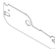
L03 PLAQUE LATÉRALE À PERSIENNES -A4M04138 (x39) 1/16 "x2 3/16" x6 9/16 "(2x55x167)
