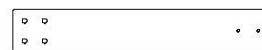
H83 | CALE DE TOBOGGAN - W4L13333 (x2) | 1 po x 3 3/8 po x 20 1/8 po (24 x 86 x 512)
