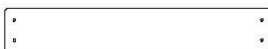
M02 | PLANCHE DE MUR D'ESCALADE - W4L16436 (x8) | 5/8 po x 3 3/8 po x 20 7/8 po (16 x 86 x 529)
