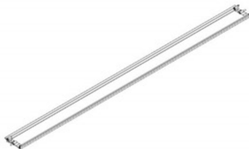
L01 MONTAJE DE PERSIANAS - A4M04137 (x20) 1 11/16"x7 5/8"x114 5/16" (42x194x2904)
