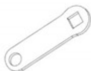
F04 (x1) CORREA DE ENLACE - A4M02225 1/8"x13/16"x2 5/8" (3x20x66)
