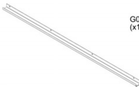
G04 CANALÓN - A4M02858 (x1) 1 9/16"x1 15/16"x65 15/16" (40x50x1675)
