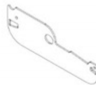
L03 (x39) PLACA LATERAL DE LAS PERSIANAS - A4M04138 1/16"x2 3/16"x6 9/16" (2x55x167)
