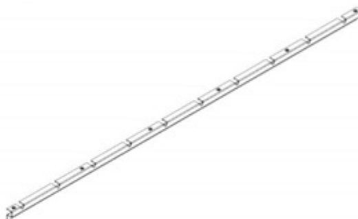
M01 SOPORTE DE LAS PERSIANAS- A4M02864 (x2) 1"x1 15/16"x65 7/8" (25x49x1673)
