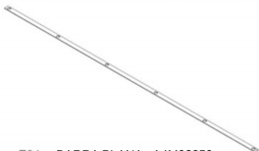
F01 BARRA PLANA - A4M02859 (x4) 1/16"x1"x65 7/8" (2x25x1673)
