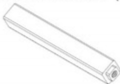
L02 (x1) PLACA LATERAL DE ACCIONAMIENTO DE LA PERSIANA- A4M04139 1/16"x2 3/16"x6 9/16" (2x55x167)
