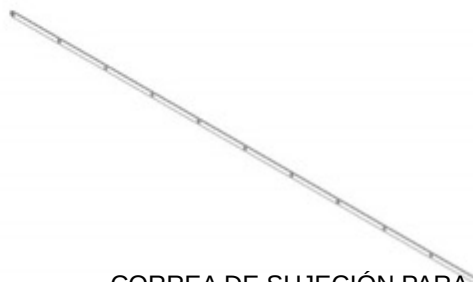
F02 CORREA DE SUJECIÓN PARA PERSIANAS - A4M02860 (x4) 1/8"x13/16"x68 1/16" (3x20x1730)
