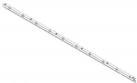
M02 SOPORTE DE PERSIANAS - A4M02865 (x1) 1"x1 15/16"x65 7/8" (25x49x1673)
