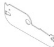
L03 PLACA LATERAL DE LAS PERSIANAS - A4M04138 (x38) 1/16"x2 3/16"x6 9/16" (2x55x167)
