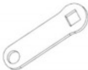
F04 CORREA DE ENLACE - A4M02225 (x1) 1/8"x13/16"x2 5/8" (3x20x66)
