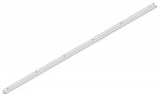
G01 CANALÓN - A4M01993 (x2) 1 9/16"x1 15/16"x108 7/8" (40x50x2765)
