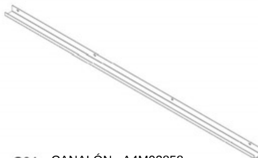
G04 CANALÓN - A4M02858 (x2) 1 9/16"x1 15/16"x65 15/16" (40x50x1675)
