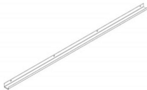
G03 CANALÓN - A4M02857 (x1) 1 9/16"x1 15/16"x65 15/16" (40x50x1675)
