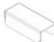
A5 SHELF BRACKET - A4M03141 (x8) 5/8"x7/8"x2 1/16" (16x22x53)
