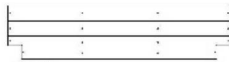
FP3 PANNEAU DE PLANCHER - W2A02749 (x1) 1 1/4 po x 11 7/8 po x 49 1/16 po (32 x 302 x 1 247)
