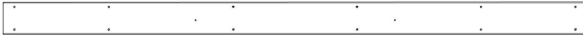
OG02 TAQUET DE SIÈGE - W4L21943 (x1) 1 3/16 po x 3 3/8 po x 60 15/16 po (30 x 86 x 1548)
