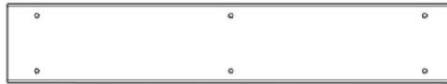
OG15 TAQUET DE SIÈGE - W4L22407 (x1) 1 3/16 po x 3 3/8 po x 19 1/8 po (30 x 86 x 486)
