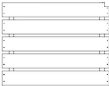
BA03 ASSEMBLAGE DU BANC - W2A04983 (x1) 1 15/16 po x 19 1/8 po x 24 13/16 po (50 x 486 x 630)
