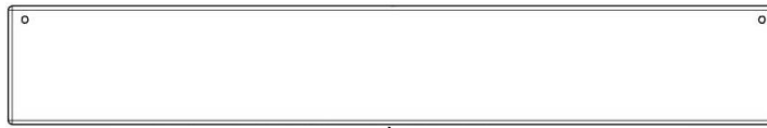
W05 GARNITURE DE SIÈGE - W4L22587 (x1) 1 9/16 po x 3 3/8 po x 22 1/16 po (40 x 86 x 560)
