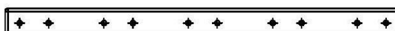
OO04 PLANCHE DE PROTECTION DU CHAUFFE-SAUNA - W4L22035 (x1) 1 3/16 po x 1 3/16 po x 16 1/8 po (30 x 30 x 410)
