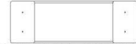
W02 ENTRETOISE DE PIED - W4L22399 (x2) 1 15/16 po x 3 3/8 po x 10 1/4 po (50 x 86 x 261)
