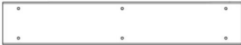
OG08 TAQUET DE SIÈGE - W4L22384 (x1) 1 3/16 po x 3 3/8 po x 19 1/8 po (30 x 86 x 486)
