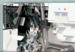
MO-214D Einfädelhilfe Untergreifer: Dank dieser kleinen Hilfe wird auch das Einfädeln des Untergreifers sehr vereinfacht.
