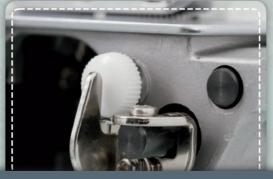
MO-204D Schnittbreitenverstellung: Breitere oder schmalere Nähte? Dazu dient die Schnittbreitenverstellung.
