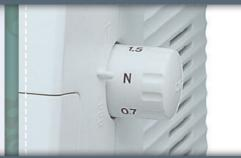
Differentialtransport: Der Differentialtransport verhilft Ihnen zu einem optimalen Stofftransport bei elastischen Stoffen.
