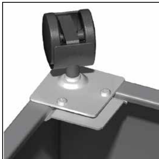
FIGURE 4 : Vue rapprochée du montage de roulette arrière.
