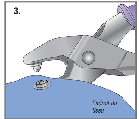
4. Pressez fermement les pincés pour appliquer le goujon et la tige. Vérifiez l'étanchéité; pressez de nouveau, au besoin.
