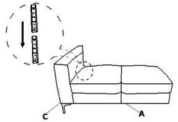
2 SLIDE THE RIGHT SIDE ARM (D) INTO RIGHT SIDE BRACKETS ON SEAT(A).
