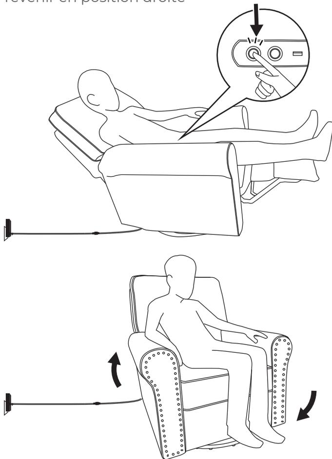
Le fauteuil retourne à la position verticale si l'on appuie sur le bouton situé du côté intérieur droit de l'appui-bras.
