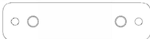
A4M01292 SUPPORT DE MONTAGE (x2)
