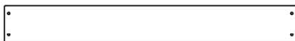
M74 | PLANCHE DE MUR D'ESCALADE - W4L16071 (x10) 5/8 po x 3 3/8 po x 26 5/8 po (16 x 86 x 675)
