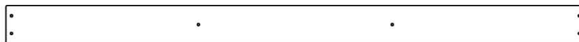
M03 | PLANCHE DE PLANCHER - W4L16063 (x20) | 5/8 po x 3 3/8 po x 50 7/8 po (16 x 86 x 1292)
