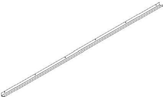
G06 CANALÓN - A4M03481 (x2) 1 \frac{9}{16}'' \times 1 \frac{15}{16}'' \times 1113 \frac{3}{4}'' (40 x 50 x 2839)
