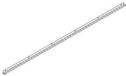
G06 CANALÓN - A4M 03481 (x2) 1 9/16" x 1 15/16" x 111 3/4" (40 x 50 x 2839)
