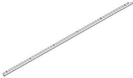
G01 CANALÓN - A4M03478 (X1) 1 9/16" x 1 15/16" x 1117 5/16" (40 x 50 x 2838)
