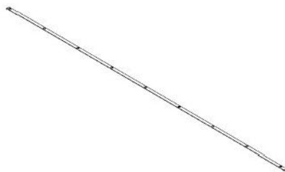
F01 BARRA PLANA - A4M02585 (x4) 1/16"x1"x110 3/4" (2x25x2813)
