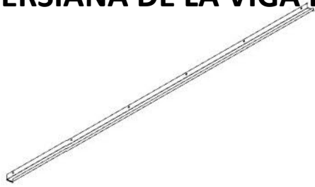
G02 CANALÓN - A4M 03481 (x1) 1 9/16" x 1 15/16" x 111 3/4" (40 x 50 x 2839)
