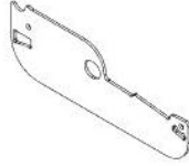
L03 PLACA LATERAL DE LAS PERSIANAS - A4M04138 (x66) 1/16"x2 3/16"x6 9/16" (2x55x167)
