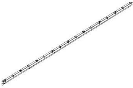
M02 SOPORTE DE REJILLA - A4M02594 (x1) 1"x1 15/16"x110 3/4" (25x49x2813)
