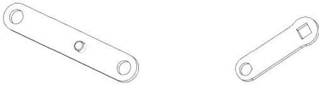
F03 CORREA DE ENLACE - -A4M02229-01 (x2) 1/8" x 11/16" x 3 13116" (3 x 17 x 97)
