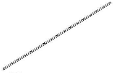
M04 SOPORTE DE REJILLA - A4M02596 (x1) 1" x 115/16" x 110 3/4" (25 x 49 x 2813)
