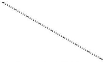
F01 BARRA PLANA - A4M02585 (x2) 1/16"x1"x110 3/4" (2x25x2813)
