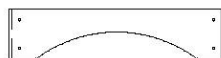
L4 | RAIL MURAL ARQUÉ GAUCHE - W4L04468 (x1) | 5/8 po x 4 3/8 po x 18 1/2 po (16 x 112 x 469)
