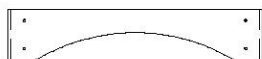
L1 | RAIL MURAL ARQUÉ - W4L04469 (x2) | 5/8 po x 4 3/8 po x 22 1/8 po (16 x 112 x 563)
