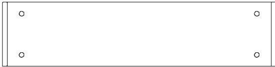
G2 | PLANCHE AU SOL - W4L04459 (x1) | 1 po x 5 1/4 po x 22 3/8 po (24 x 134 x 570)
