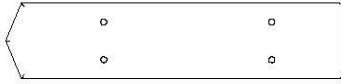
N1 TAQUET D'ÉTAGÈRE - W4L04548 (x2) 5/8 po x 2 3/8 po x 10 1/2 po (16 x 60 x 268)
