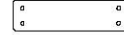
N7 | BLOC D'ATTACHE DE TAQUET DE TOIT - W4L04874 (x2) | 5/8 po x 1 5/8 po x 6 po (16 x 40 x 152)
