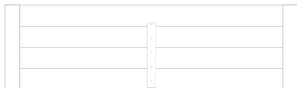
RP1 | PANNEAU DE TOIT INFÉRIEUR - W2A02982 (x2) | 1 3/8"x13"x44 7/8" (35x329x1140)
