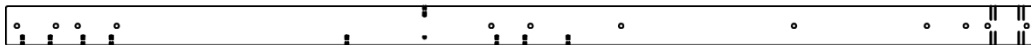
E01 | PATA DELANTERA DERECHA DE LA TORRE - W4L15999 (x1) | 1 3/8"x3 3/8"x89 1/2" (36x86x2274)
