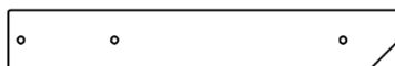
M14 | SOPORTE DEL ASIENTO DE LA MESA PICNIC - W4L16050 (x2) | 5/8"x3 3/8"x22" (16x86x558)
