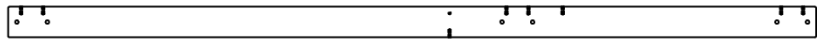
E03 | PATA DELANTERA IZQUIERDA DE LA TORRE - W4L16001 (x1) 3/8"x3 3/8"x89 1/2" (36x86x2274)
