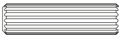
(E) Wooden dowel/ Clavija de madera/ Manchon en bois X 2 (ø8 X 30mm)
