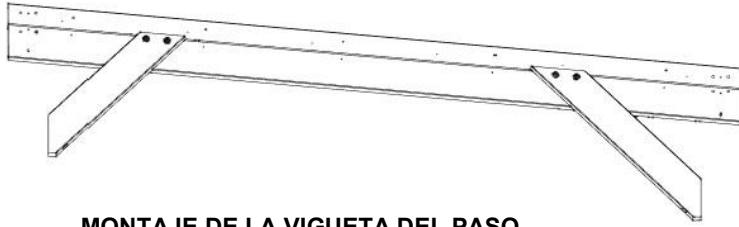
MONTAJE DE LA VIGUETA DEL PASO ANTERIOR
