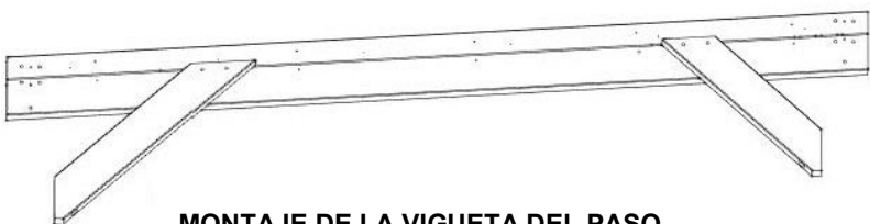
MONTAJE DE LA VIGUETA DEL PASO ANTERIOR
