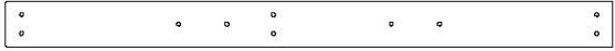
Q02 LISSE DE PLANCHER - W4L15721 (x1) 1 po x 4 3/8 po x 57 1/2 po (24x112x1460)
