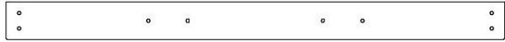
Q03 LISSE DE PLANCHER - W4L15724 (x1) 1 po x 4 3/8 po x 57 1/2 po (24x112x1460)
