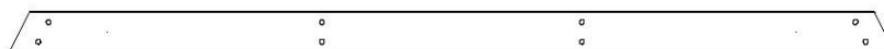
H82 | PLANCHE DE SOL DE BARRE DE SUSPENSION - W4L15714 (x1) | 1 po x 3 3/8 po x 70 3/8 po (24x86x1786)
