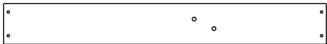
M75 | PLANCHE DE MUR D'ESCALADE - W4L16072 (x4) 5/8 po x 3 3/8 po x 26 5/8 po (16 x 86 x 675)
