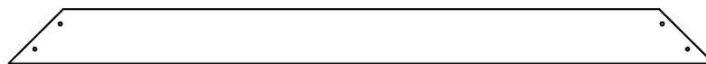
M04 | PLANCHE DE RIVE DU PIGNON - W4L16065 (x2) | 5/8 po x 3 3/8 po x 44 po (16 x 86 x 1118)
