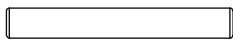
E METAL PIN/ TIGE MÉTALLIQUE/ AGUJA DE METAL X 1 (Ø4 X 30MM)
