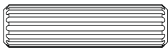
(G) Wooden dowel/ Clavija de madera/ Manchon en bois X 5 (ø8 X 30mm)
