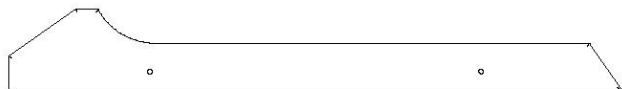
M33 | BORDURE DE TOIT - W4L17867 (x2) | 5/8 po x 3 3/8 po x 25 5/8 po (16x86x652)
