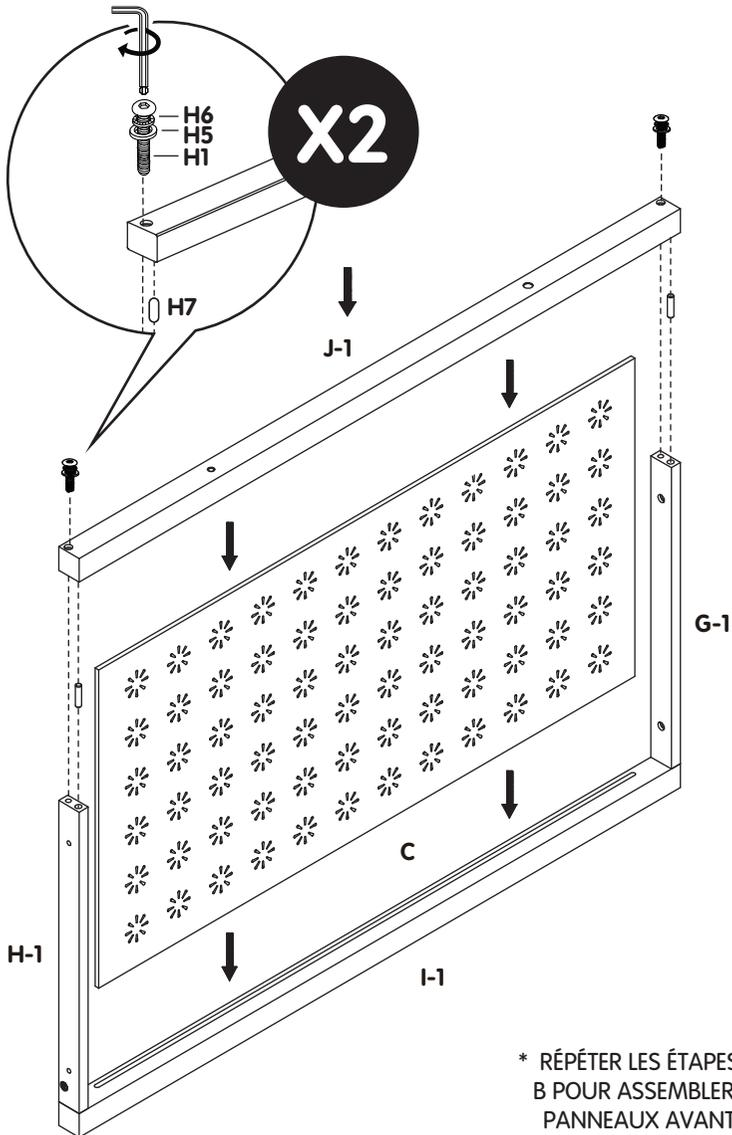
\* RÉPÉTER LES ÉTAPES A ET B POUR ASSEMBLER LES PANNEAUX AVANT ET ARRIÈRE.
