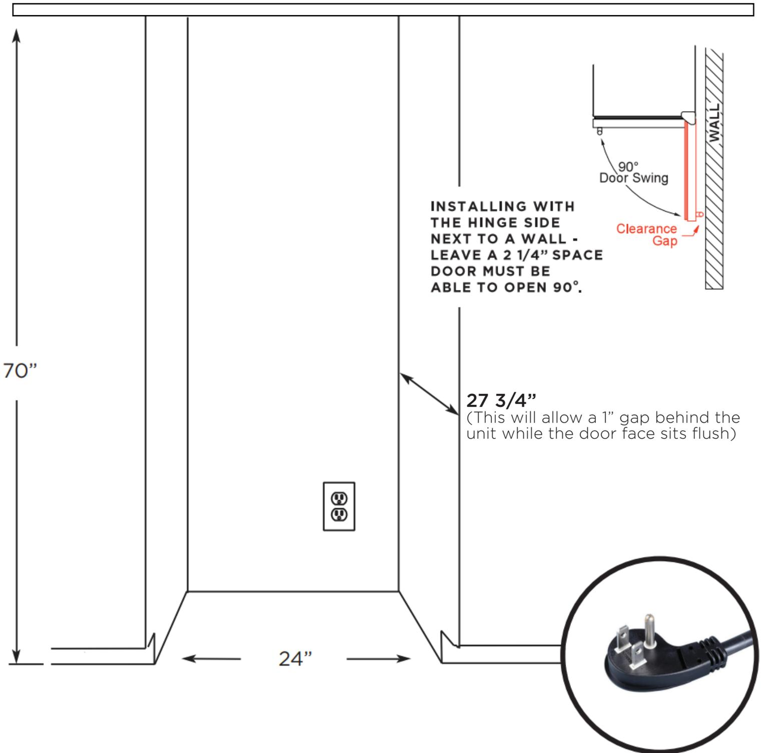
**IF THE DOOR CAN'T OPEN FULLY - YOU CAN'T PULL THE RACKS OUT.**
