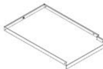
C5 ÉTAGÈRE DE L'ARMOIRE DU FOUR À PIZZA - A4M03074 (x1) 2 3/8"x14 7/8"x23 1/16" (60x378x585)
