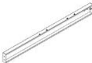
O10 MONTAGE VERTICAL DE GLISSIÈRE DU FOUR À PIZZA - A4M03079 (x1) 1 3/16"x2 15/16"x33 1/4" (30x75x844)
