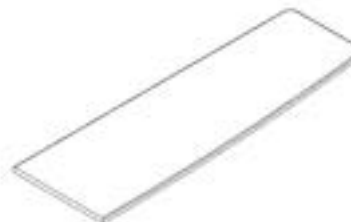
M6 PLATEAU DE BAR DROIT EN MARBRE - A4M03020 (x1) 11/16"x14 1/16"x43 7/16" (18x358x1103)
