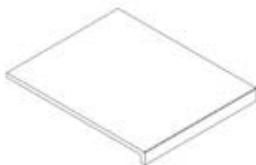
M3 PANNEAU DE MARBRE DU FOUR À PIZZA R - A4M03090 (x1) 1 15/16"x20"x24 13/16" (50x508x630)
