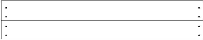
RP1 PANNEAU DE TOIT - W2A03407 (x1) 1 5/8 po x 10 3/8 po x 53 3/4 po (42x264x1364)
