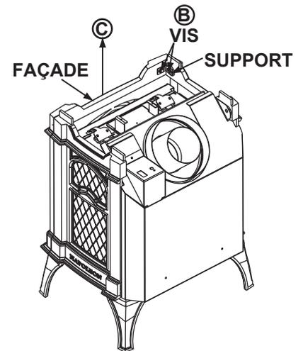
Pour réinstaller la porte, suivez les étapes ci-dessus dans l'ordre inverse. Avant de verrouiller les loquets, assurez-vous que le bas de la porte est bien installé dans le support de retenue.
