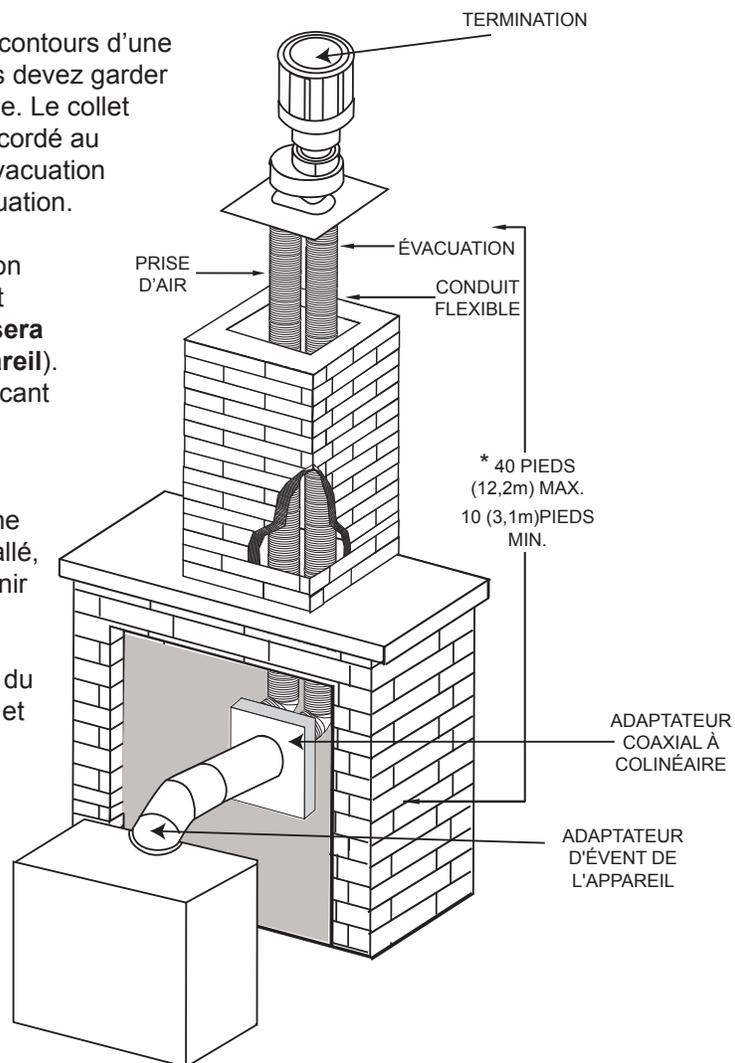
\* Mesurée à partir de la buse de l'appareil jusqu'au collet de la terminaison.
