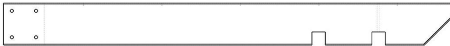
D14 | SOLIVE À FENTE - W4L15515 (10) | 1 3/8 po x 5 1/4 po x 55 3/4 po (36 x 134 x 1 416)
