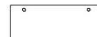
N5 PLANCHE DE FENÊTRE D'OBSERVATION - W4L14606 (x6) 5/8 po x 2 3/8 po x 6 1/4 po (16 x 60 x 158)
