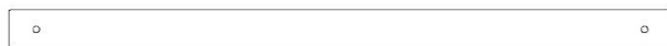
N1 PLAQUE DE SÉCURITÉ - W4L14602 (x1) 5/8 po x 2 3/8 po x 40 3/8 po (16 x 60 x 1024)
