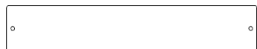
N4 PLANCHE DE FENÊTRE D'OBSERVATION - W4L14605 (x2) 5/8 po x 2 3/8 po x 13 1/8 po (16 x 60 x 332)
