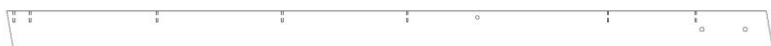
E6 MONTANT DE BARRES DE SUSPENSION - W4L22700 (x1) 1 3/8 po x 3 3/8 po x 71 x 3/8 po (36 x 86 x 1812)
