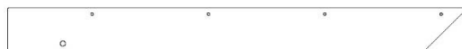
H13 CHEVRON DE TOIT - W4L22698 (x4) 1 po x 3 3/8 po x 34 1/4 po (24 x 86 x 871)
