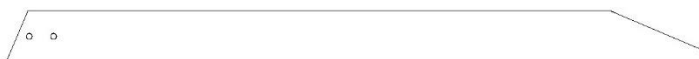
OG03 CONTREVENTEMENT D'ANGLE - W4L22674 (x2) 1 x 3/16 po x 3 3/8 po x 47 po (30 x 86 x 1194)
