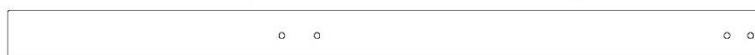
SP01 SUPPORT POUR POUTRE DE BALANÇOIRE - W4L21497 (x1) 3 3/8 po x 3 3/8 po x 50 5/8 po (86 x 86 x 1286)
