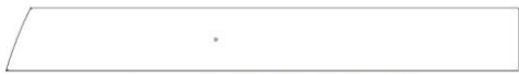
L8 PLANCHE DE PORTE - W4L14570 (x1) 5/8 po x 4 3/8 po x 35 po (16 x 110 x 890)
