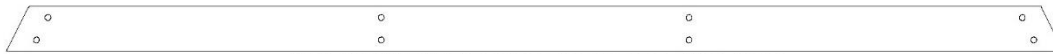
HB5 PLANCHE DE SOL POUR BARRES DE SUSPENSION - W4L22702 (x1) 1 po x 3 po x 70 3/4 po (24 x 76 x 1798)
