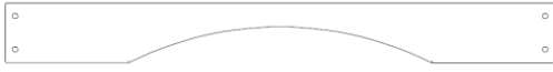
L5 | RAMPE MURALE DE MAISONNETTE - W4L14567 (x1) 5/8 po x 4 3/8 po x 40 3/8 po (16 x 112 x 1024)
