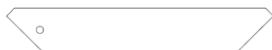
OR01 | CONTREVENTEMENT DE TERRASSE - W4L22675 (x6) 1 1/8 po x 2 3/8 po x 14 5/8 po (30 x 60 x 371)
