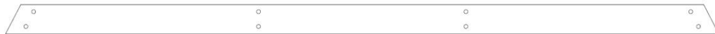
HB5 PLANCHE DE SOL POUR BARRES DE SUSPENSION - W4L22702 (x1) 1 po x 3 po x 70 3/4 po (24 x 76 x 1798)
