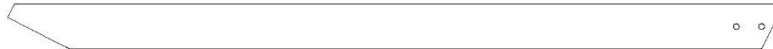
HB4 CONTREVENTEMENT DE BARRES DE SUSPENSION - W4L22701 (x2) 1 1/8 po x 3 po x 52 po (30 x 76 x 1320)
