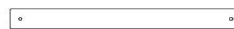
O2 PANNEAU MURAL - W4L14610 (x2) 5/8 po x 1 3/8 po x 15 1/2 po (16 x 34 x 395)
