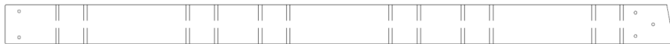
A01 POUTRE DE BALANÇOIRE - W4L21496 (x1) 3 3/8 po x 5 1/4 po x 89 1/2 po (86 x 134 x 2274)
