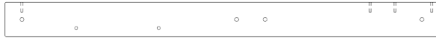
E8 | MONTANT DE MAISONNETTE - W4L14537 (x1) | 1 3/8 po x 3 3/8 po x 43 1/8 po (36 x 86 x 1094)
