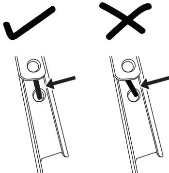
S'assurer que le mécanisme de verrouillage de chaque rail métallique est aligné au **centre**.
