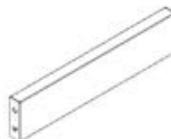
A3 CANAL HORIZONTAL - A4M03071 (x5) 1"x3 3/8"x15 3/16" (25x85x386)
