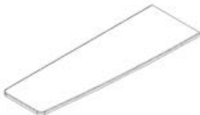
M7 PLATEAU DE BAR GAUCHE EN MARBRE - A4M03021 (x1) 11/16"x14 1/16"x43 7/16" (18x358x1103)
