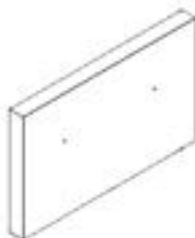
D9 MONTAGE DU PANNEAU DE TIROIR - A4M03080 (x4) 1 5/16"x10 1/4"x16 1/2" (34x260x419)
