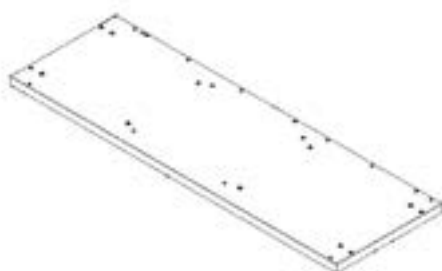
F5 MONTAGE DE PANNEAU DE PLANCHER D'ARMOIRE D'ÉVIER - A4M03092 (x1) 2 5/8"x23 3/8"x72 3/16" (66x594x1834)
