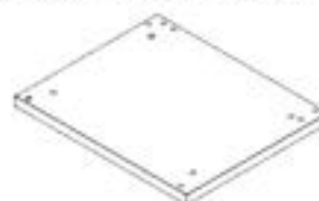
T5 PANNEAU DE L'ARMOIRE D'ANGLE EN MARBRE DU FOUR À PIZZA DROIT - A4M03069 (x1) 1 1/4"x20"x24 1/8" (32x508x612)
