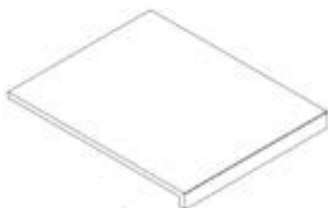
M3 ARMOIRE DU FOUR À PIZZA EN MARBRE DROIT - A4M03090 (x1) 1 15/16"x20"x24 13/16" (50x508x630)
