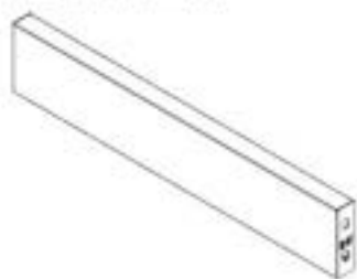
A4 CANAL LATÉRAL DE L'ARMOIRE D'ÉVIER- A4M03097 (x1) 1"x3 3/8"x18 3/8" (25x85x466)
