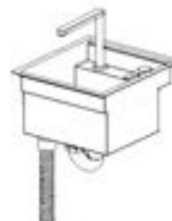
A16 ASSEMBLAGE D'ÉVIER - A4M03143 (x1) 15 1/8"x15 5/16"x16 7/8" (384x389x429)
