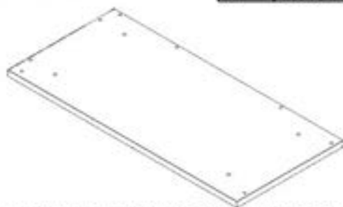
T1 PANNEAU DE L'ARMOIRE D'ANGLE EN MARBRE L - A4M03034 (x1) 1 1/4"x24 1/8"x51 7/8" (32x612x1317)
