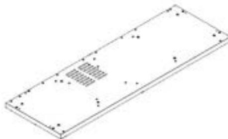
F4 ASSEMBLAGE DE PLANCHER DE L'ARMOIRE DU FOUR DE PIZZA- A4M03062 (x1) 2 5/8"x23 3/8"x72 3/16" (66x594x1834)
