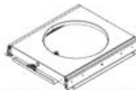
A13 MONTAGE DE HAUSSE DE BONBONNE DE GAZ - A4M03047(x2) 1 15/16"x12 7/8"x14 3/4" (49x327x374)
