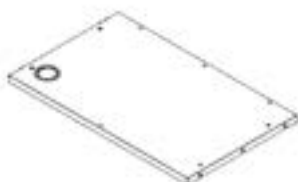
T2 MONTAGE DU PLATEAU DE TABLE DE GRIL - A4M03057 (x1) 1 1/4"x23 3/8"x38 3/16" (32x594x970)
