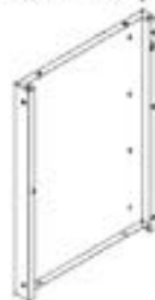
G1 MUR LATÉRALE DE L'ARMOIRE D'ANGLE GAUCHE - A4M03029 (x1) 2 9/16"x23 3/8"x33 3/8" (65x594x848)
