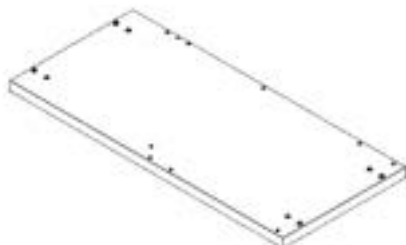
F3 MONTAGE DE PANNEAU DE PLANCHER D'ARMOIRE DE COIN - A4M03039 (x1) 2 5/8"x23 3/8"x51 7/8" (66x594x1317)
