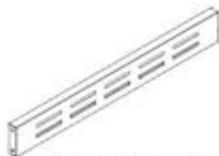
O8 GRILLE DE VENTILATION DE FOUR À PIZZA- A4M03078 (x1) 1 3/16"x4"x31 7/16" (30x102x798)
