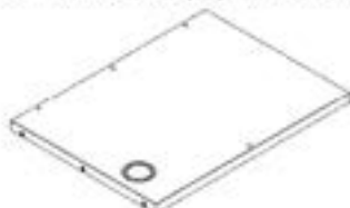
T6 MONTAGE DU PLATEAU DE TABLE DU FOUR À PIZZA - A4M03070 (x1) 1 3/8"x23 3/8"x31 7/16" (35x594x796)
