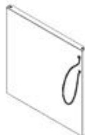
G5 MONTAGE DU MUR DE PANNEAU D'ELATÉRALE DE GRIL - A4M03050(x1) 1 3/4"x22 13/16"x23 1/4" (44x579x591)
