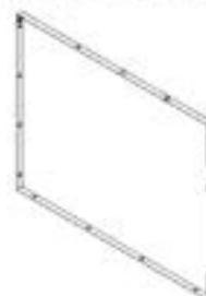
S5 MONTAGE PANNEAU LATÉRAL DE L'ARMOIRE D'ÉVIER - A4M03098 (x1) 1 3/16"x33 3/8"x42 1/8" (30x848x1070)
