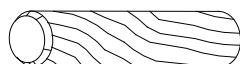
N Ø8 x 30mm Wood Dowel de la cheville en bois la espiga de madera x21
