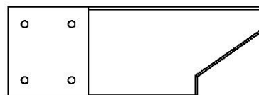
D2 | EXTRÉMITÉ DE SOLIVE - W4L16248 (1) | 1 7/16 po x 5 1/4 po x 15 po (36x134x381)
