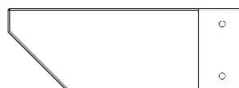
D05 | EXTRÉMITÉ DE SOLIVE - W4L15529 (2) | 1 3/8 po x 5 1/4 po x 15 po (36 x 134 x 382)
