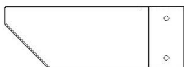
D03 | EXTRÉMITÉ DE SOLIVE - W4L15502 (2) | 1 3/8 po x 5 1/4 po x 15 po (36 x 134 x 382)
