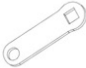
F04 LINKAGE STRAP - A4M02225 (x1) 1/8"x13/16"x2 5/8" (3x20x66)
