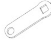
F04 LINKAGE STRAP - A4M02225 (x1) 1/8"x13/16"x2 5/8" (3x20x66)
