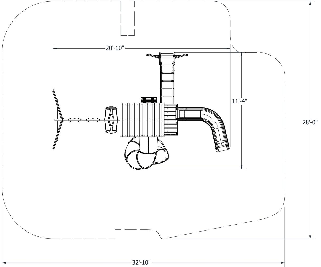
MINIMUM USE ZONE FOR PLAY EQUIPMENT SHALL EXTEND NO LESS THAN 72" FROM ALL SIDES OF THE PLAY STRUCTURE.
