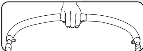
Para ajustar la altura de la manija, oprima la palanca central de liberación y deslice hacia arriba o hacia abajo.
