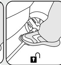
Pise sobre la parte delantera de las palancas de freno para bloquear los frenos.
