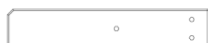
H16 | RAIL DE SIÈGE POUR TABLE DE PICNIC - W4L12721 (1) | 1"x3 3/8"x17 1/2" (24x86x444)
