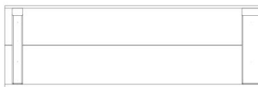
RP4 PANNEAU DE TOITURE DU SOMMET DU PORCHE DROIT - W2A02653 (1) 1 5/8"x10 1/2"x32 7/8" (42x268x834)
