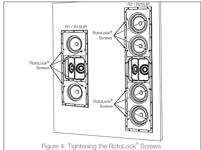
**IMPORTANT: ALWAYS USE LOW-TORQUE SETTINGS; NEVER OVER TIGHTEN. NOTE: ADJUSTING THE TENSION OF THE ROTOLock® CLAMPS SO THAT THE SPEAKER FRAME IS FLAT WILL HELP ENSURE THAT THE GRILLE CONTACTS THE WALL ALL THE WAY AROUND THE SPEAKER FOR A PROPER FIT.**
