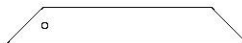
F1 | CALE DE LA PLATEFORME - W4L14541 (x6) | 1 po x 2 3/8 po x 15 3/4 po (24x60x400)
