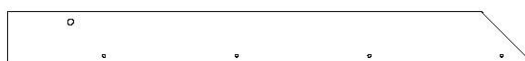
M27 | CHEVRON DE TOIT - W4L14597 (x4) | 5/8 po x 3 3/8 po x 34 1/4 po (16x86x871)
