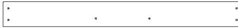
M31 | PLANCHE DU PIGNON - W4L14599 (x2) | 5/8 po x 3 3/8 po x 31 1/2 po (16x86x800)
