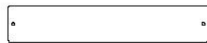
N4 | PLANCHE DE FENÊTRE EN BAIE - W4L14605 (x6) | 5/8 po x 2 3/8 po x 13 1/8 po (16x60x332)
