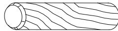
11 WOOD DOWEL/ SERVIETTE EN BOIS/ CLAVIJA DE MADERA x 20 (Ø8 X 30MM)
