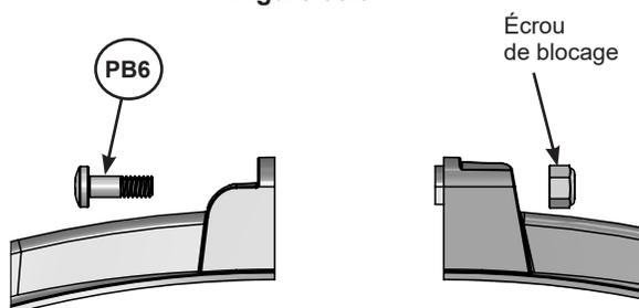
Après que les anneaux de serrage sont fixés sur les coudes, reliez leurs bouts avec deux boulons à tête bombée et des écrous de blocage
