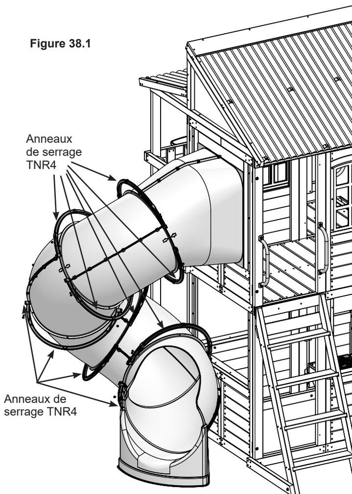
Remarque : Pour faciliter l'assemblage, on peut faire pivoter les anneaux du bas de 90 degrés pour poser les boulons.
