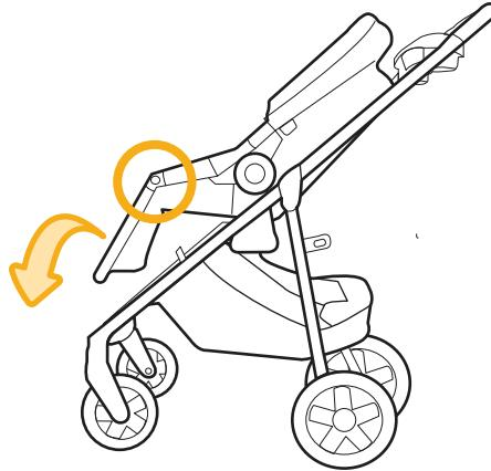
**Pour abaisser le repose-pieds**, appuyez sur les boutons de réglage du repose-pieds et poussez le repose-pieds vers le bas.
