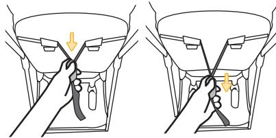
Inclinez complètement le dossier du siège de la poussette. À l'arrière du siège de la poussette, appuyez sur le bouton de réglage du dossier et tirez-le vers vous.
