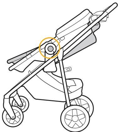
Repérez les boutons de réglage du siège de la poussette de chaque côté du siège de la poussette.
