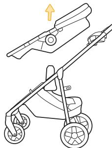
Appuyez à fond sur les boutons de dégagement de chaque côté du siège et soulevez et retirez le siège de la poussette du cadre de la poussette.
