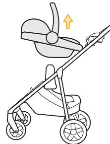
Tout en engageant le mécanisme de verrouillage de la poussette de votre siège d'auto, soulevez le siège d'auto du cadre de la poussette.
