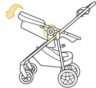
Appuyez sur les boutons de dé-gagement du siège de la poussette et faites tourner le siège complètement vers l'arrière. .
