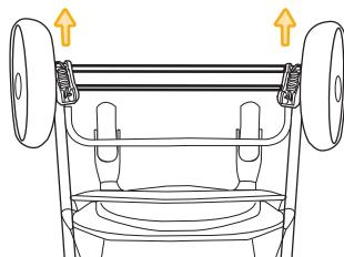
Appuyez sur les boutons de dégagement tout en tirant l'assemblage de roue arrière vers le haut et en le tirant en l'éloignant de la poussette.
