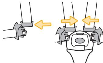
Alignez la languette de la boucle avec la languette de la boucle. Faites glisser en place.
