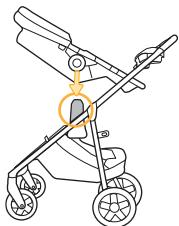
Installez le siège de la poussette orienté vers l'arrière ou vers l'avant sur les fixations sur le cadre de la poussette. Vous entendrez un "clic" de chaque côté lorsqu'il sera verrouillé en place.
