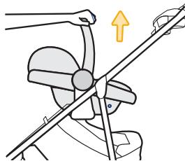
Tirez le siège d'auto vers le haut au niveau de la poignée de transport ou des moyeux de la poignée pour vérifier s'il est bien fixé.
