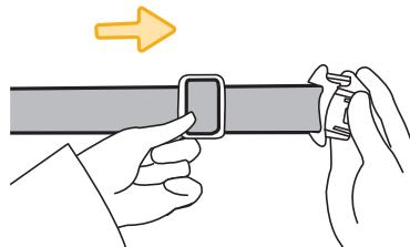
Tenez la bague coulissante d'une main et la pince de la boucle de l'autre. Faites glisser la bague vers la pince de la boucle.
