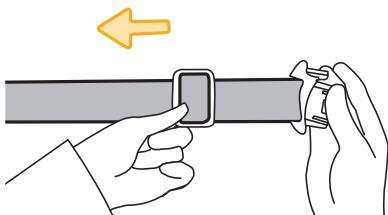
Tenez la bague coulissante d'une main et la pince de la boucle de l'autre. Faites glisser la bague en l'éloignant de la pince de la boucle.
