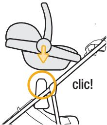
Fixez le siège d'auto orienté vers l'arrière ou vers l'avant aux fixations sur le cadre de la poussette.
