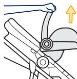
Tirez le siège d'auto vers le haut au niveau de la poignée ou des moyeux de poignée pour vérifier s'il est bien fixé.
