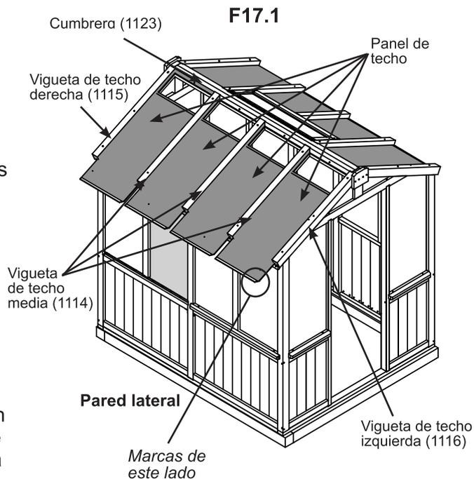
*Nota: El lado con protección UV debe orientarse hacia el exterior del almacén.*
