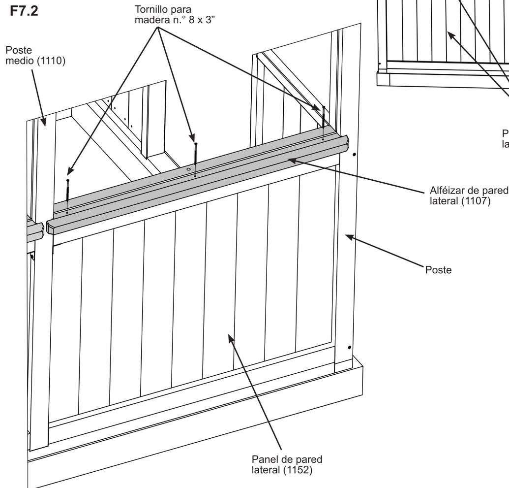
*Apoye los separadores guía en las muescas de los postes y del alféizar de pared lateral a fin de alinear los alféizares de pared lateral correctamente y, luego, retírelos.*
