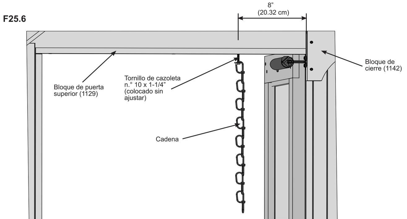
**F:** Mida 5" (12.7 cm) desde el extremo del panel de puerta (1175) y, luego, fije el soporte de cadena con dos tornillos de cazoleta n.º 10 x 1-1/4". (F25.6 y F25.7)
