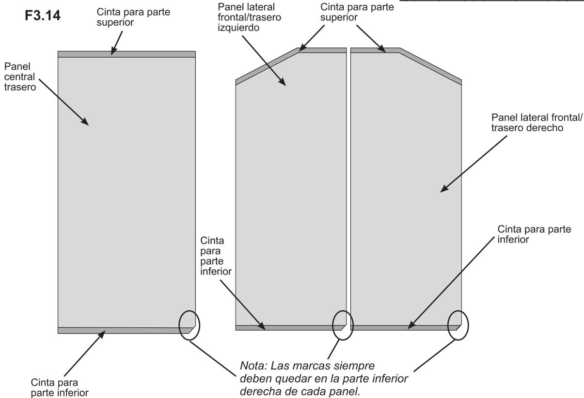
*Nota: El lado con protección UV debe orientarse hacia el exterior del armazón.*
