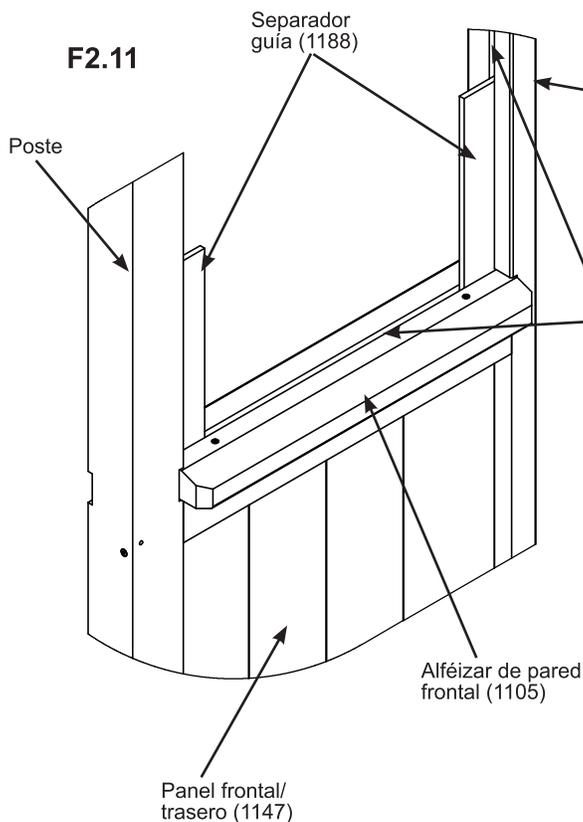
*Apoye los separadores guía en las muescas de los postes, los postes de puerta y los alféizares de pared frontal a fin de alinear los postes correctamente y, luego, retírelos.*
