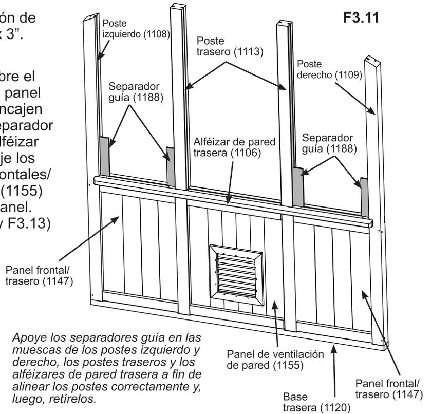
Apoye los separadores guía en las muescas de los postes izquierdo y derecho, los postes traseros y los alféizares de pared trasera a fin de alinear los postes correctamente y, luego, retirelos.
