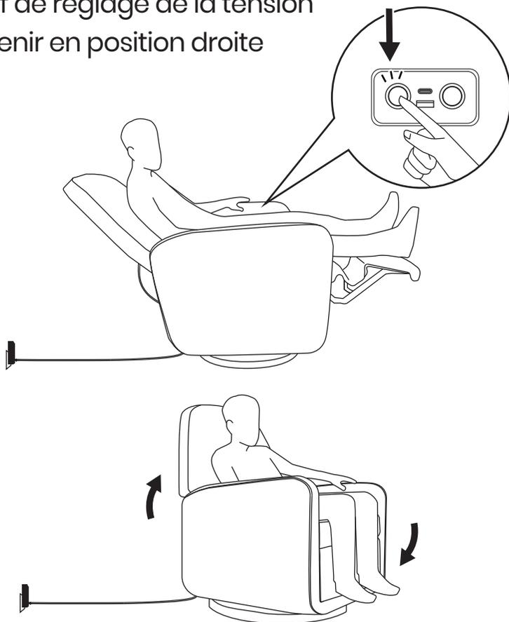
Le fauteuil retourne à la position verticale si l'on appuie sur le bouton situé du côté intérieur droit de l'appui-bras.
