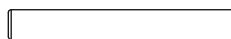
K Metal Pin/ Pin en métal/ Aguja de metal X 1 (Ø4 X 30MM)
