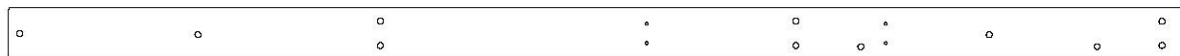
H6 | LISSE DE PLANCHER - W4L06435 (x1) | 1 po x 3 3/8 po x 76 7/8 po (24x86x1952)
