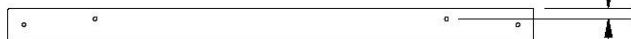
H2 | LISSE DE PLANCHER - W4L06392 (x1) | 1 po x 3 3/8 po x 54 7/8 po (24x86x1394) 1 1/8 po [27 mm]
