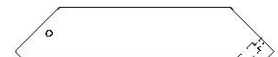
E13 | CALE DE LA PLATEFORME - W4L16880 (x8) | 1 3/8 po x 3 3/8 po x 16 7/8 po (36x86x428)
