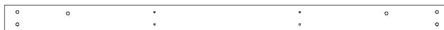
H3 | LISSE DE PLANCHER - W4L06395 (x1) | 1 po x 3 3/8 po x 56 3/4 po (24x86x1442)
