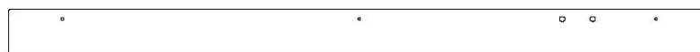
M11 | PLANCHE D'ANGLE AVANT - W4L16903 (x2) | 5/8 po x 3 3/8 po x 51 po (16x86x1297)
